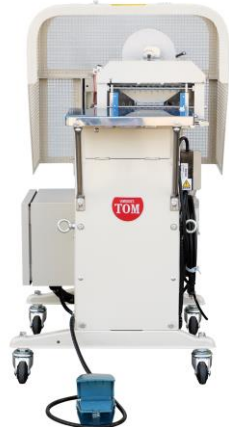
Y10C型『ジャバラ装置付き結束機』 (結束時間 3秒/結束) (コンプレッサー 0.4kW相当)
